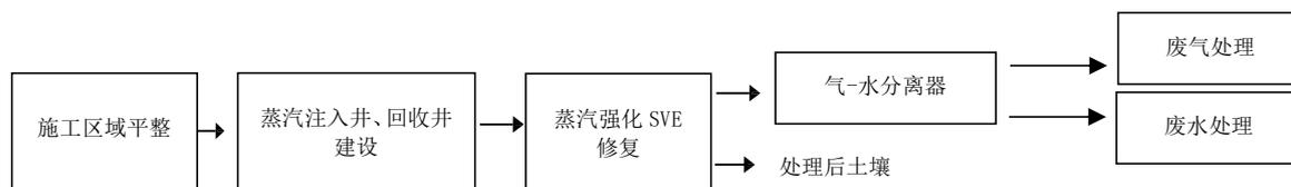
图A.14 热处理技术修复污染土壤的工艺流程
